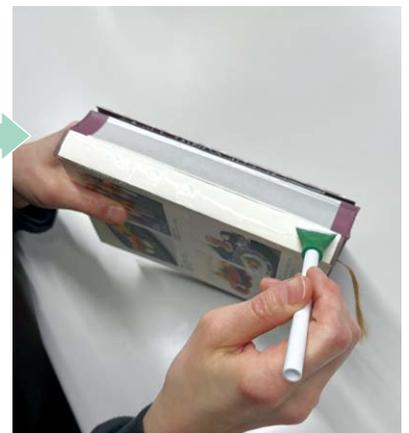
取れている部分に図書修理用の糊を塗って接着します。資料の状態によっては、中性紙で作った輪を中に入れて背を補強することもあります。
