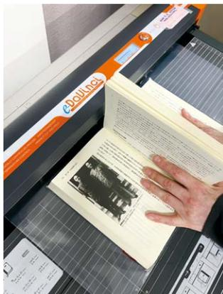
さらに、資料のサイズに合わせた透明ブックカバーが作成できる機械を使って、破損した資料を保護します。透明ブックカバーは資料に負担をかけずに補修できる点が優れています。
